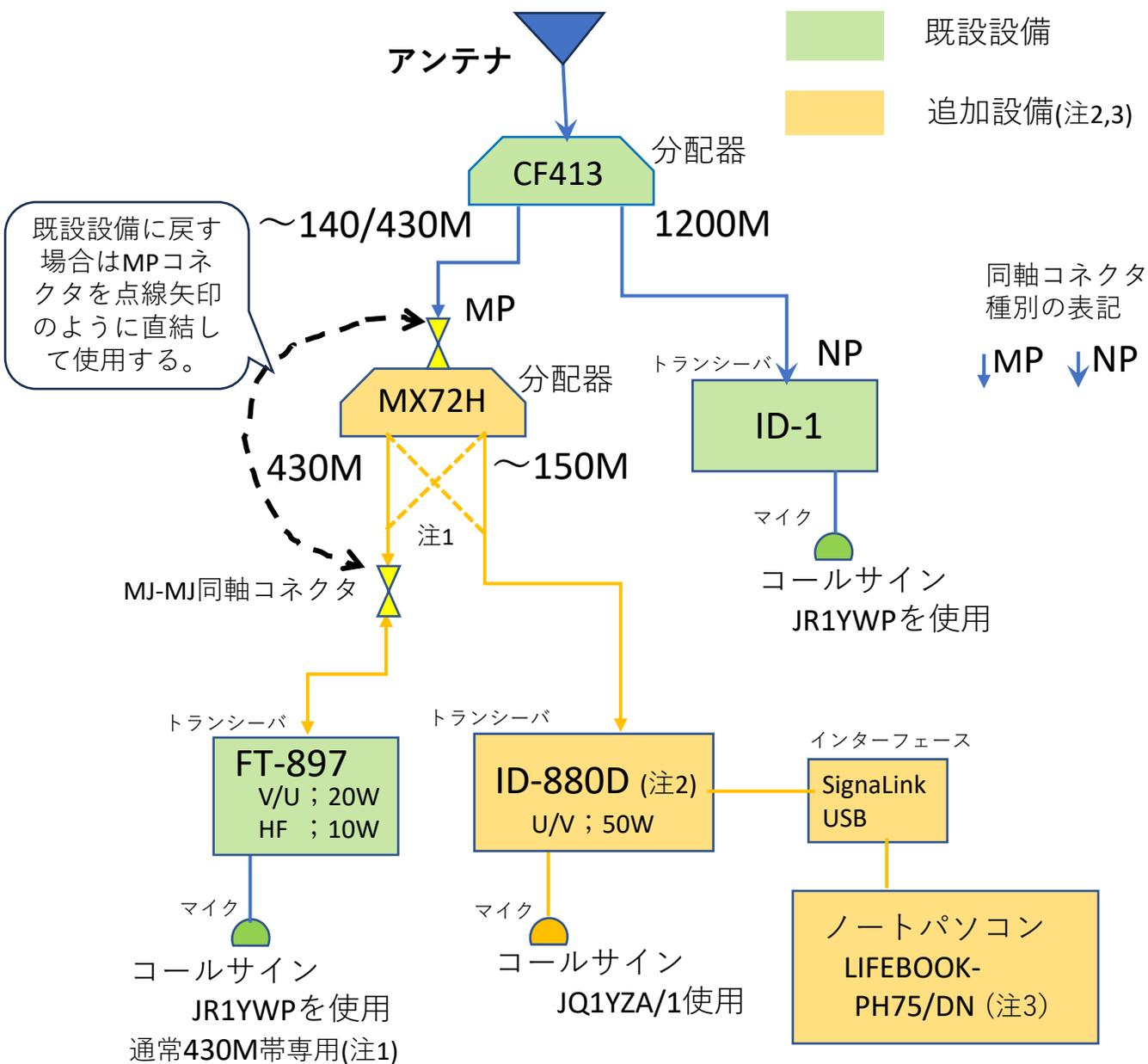
注1；JR1YWPで140M帯に運用するにはMX72H分配器の分岐先コネクタを差替える。この時ID880Dは430M帯に運用可能。
